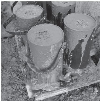
Figura 23.1 Molde para corpo de prova do graute.
