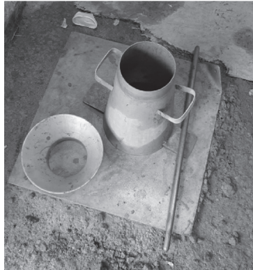
Figura 24.3 Ensaio de abatimento ( slump test ).
