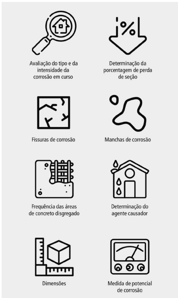
Figura 8.7 Alternativas para investigação do estado de conservação de estruturas de concreto armado.
