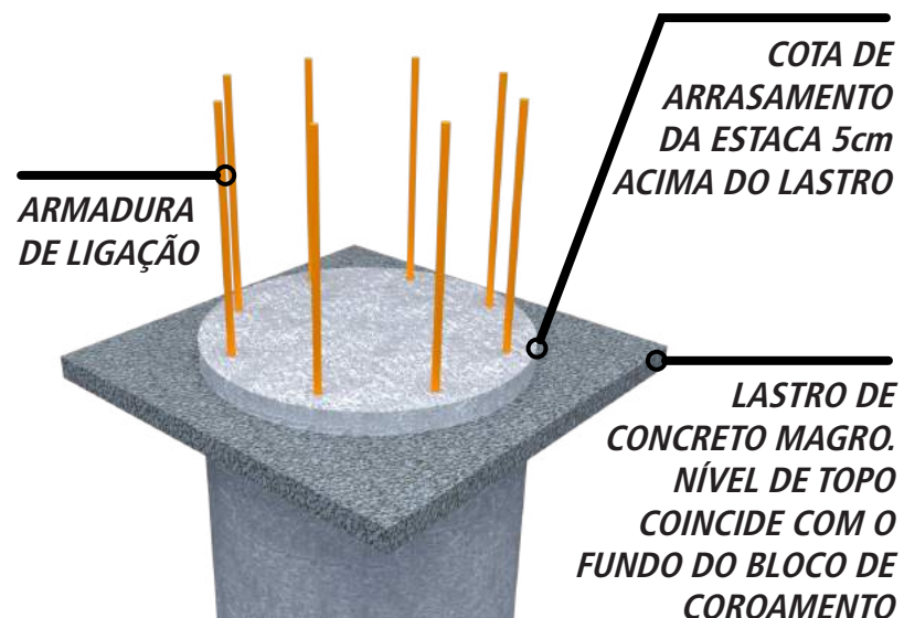
Figura 3.5 Ligação entre estaca e bloco de coroamento
