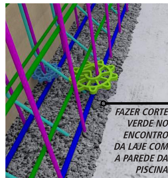
Figura 6.18 Concretagem da laje de fundo
