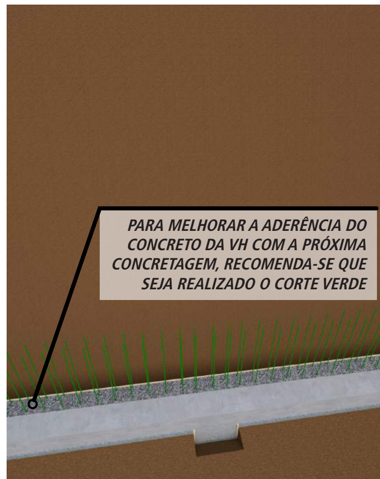
Figura 5.3 ETAPA 2 | VH concretada com os arranques da cortina
